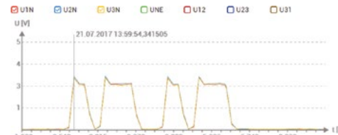
Sekwencja impulsów sterujących (widok przez serwer www PQx000)
