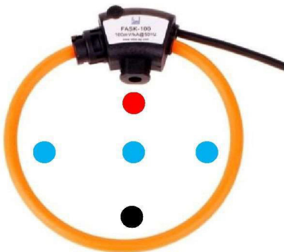
Rys. 5: Położenie przewodu strony pierwotnej z typowymi wartościami błęd pomiaru
