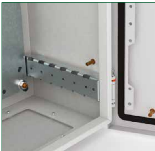
Możliwość podparcia przewodów, wykonania zabudowy wewnętrznej i regulacji głębokości zainstalowanych akcesoriów w 25 mm odstępach dzięki uniwersalnym wzmocnieniom poprzecznym (z frontem wpinanym do uniwersalnych wsporników).
