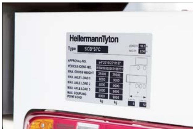
Tabliczka znamionowa przyczepy ciężarowej z laminatem ochronnym.
