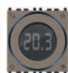
02972.M Termostat z okretnym kociącym (grijanje i klimatizacija), upravljačkim sklopom za UKLJUČIVANJE/ISKLUČIVANJE (klasa I, doprinos energetskej učinkovitosti 1%), PI (klase IV, doprinos energetskej učinkovitosti 2%), moguće spajanje sučeljem s aktivatorom KNX za modulirajući termostat pro- stora (klase V, doprinos energetskej učinkovitosti 3%), 1 ulaz za senzor 20432, 19432, 14432 ili 02965.1, 1 programowalne wejście cyfrowe - 2 modula. Głębokość: 28,5 mm
