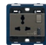
■ 19266.A.M SICURY 2P+E 13 A 250 V~ multistandardowy z przełącznikiem 2P wyjście USB typu A. Głębokość: 21 mm
