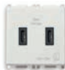
14295.CC 5 V 3 A, 2 wyjścia USB-C zapewniające łącznie 3 A, 120-240 V~ 50/60 Hz - 2 moduły. Głębokość: 29 mm
