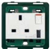
■ 14223.A SICURY 2P+E 13 A 250 V~ z przełącznikami 2P i wyjściem USB typu A. Głębokość: 21 mm
