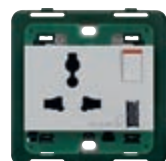
■ 14266.A.SL SICURY 2P+E 13 A 250 V~ multystandardowy z przełącznikiem 2P wyjście USB typu A. Głębokość: 21 mm
