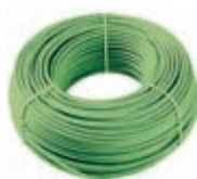
01890.C Kabel KNX, 2x2x0,8 mm, z osłoną z LSZH, Klasa CPR Cca s1b d1 a1, nadaje się do instalacji przy użyciu przewodów kategorii I (U0 = 400 V), zielony - 100 m
