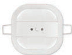
01527 Wykrywacz z czujnikiem obecności na podczerwień o zakresie działania 360° do ciągłego włączania/wyłączania światła, ogrzewania, klimatyzacji, wentylacji w zależności od naświetlenia i/lub ruchu, regulowane pole naświetlenia w zakresie 1-1000 luksów, standard KNX, instalacja na suficie. Wymiary: 80x80x45 mm
