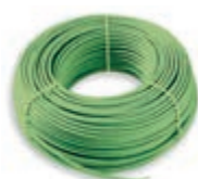
01890.E Kabel KNX, 2x2x0,8 mm, z osłoną z LSZH, Klasa CPR Eca, nadaje się do instalacji przy użyciu przewodów kategorii I (U0 = 400 V), zielony - 100 m
