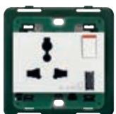
■ 14266.A SICURY 2P+E 13 A 250 V~ multystandardowy z przełącznikiem 2P wyjście USB typu A. Głębokość: 21 mm
