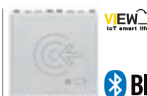
20462.N Zewnętrzny czytnik inteligentnych kart NFC/RFID przed drzwiami, konfiguracja kart za pomocą aplikacji View Wireless standardowa technologia Bluetooth, technologia IoT na standardowej technologii bezprzewodowej Bluetooth® 5.0 do wdrożenia systemu View Wireless mesh, 1 wyjście przekaznikowe NO 16 A 100-240 V~ 50/60 Hz, 1 wejście DND, dioda LED z regulacją intensywności świecenia, zasilanie 100-240 V~ 50/60 Hz - 2 moduły. Głębokość: 32 mm
