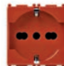
14210.AB.R Gniazdo SICURY 2P+T 16 A 250 V~, uniwersalne, czer- wone - 2 moduły. Głębokość: 25 mm
