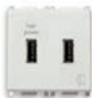
14295 5 V 2,1 A, 2 wyjścia USB-A zapewniające łącznie 2,1 A, 120-230 V~ 50/60 Hz - 2 moduły. Głębokość: 36 mm
