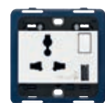
■ 19266.A.B SICURY 2P+E 13 A 250 V~ multistandardowy z przełącznikiem 2P wyjście USB typu A. Głębokość: 21 mm
