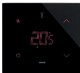
21514.F76 Termostat z ekranem dotykowym (ogrzewanie i klimatyzacja), polecenie FAN-COIL z 3-stopniową regulacją prędkości i regulacją proporcjonalną, sterowanie włączaniem/wyłączaniem (klasa I, udział 1%), PWM, PID (klasa IV, udział 2%), możliwość podłączenia siłownika 01466.1 do modulującego termostatu pokojowego (klasa V, udział 3%), 1 wejście dla czujnika 20432, 19432 lub 14432 lub czujnika przewodowego 02965.1, 1 programowalne wejście cyfrowe, podświetlenie LED RGB, black diamond - 2 moduły. Głębokość: 30,2 mm
