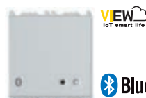
14590.SL 1 Wzmacniacz stereo 4+4 W, 2 wyjścia dla dyfuzorów akustycznych 8 Ω z wbudowanym odbiornikiem Bluetooth ® obsługującym technologię bezprzewodową, 1 wejście LINE IN, zasilanie 12 Vdc - 2 moduły. Głębokość: 36 mm
