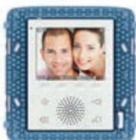
Δ 19558.B 3,5" ekran dotykowy do pomieszczenia, w którym zainstalowany jest wideofon Due Fili Plus, wejście czujnika temperatury, wspornik do instalacji w puszkach 8-modułowych. Głębokość: 25,5 mm
