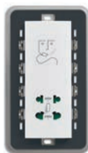
20291.B 6 230 V~ 50/60 Hz, z izolowanym transfor- matorem 20 VA, wyj- ścia 120 V~ i 230 V~. Głębokość: 41 mm
