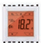
02952.B Elektroniczny termostat z ekranem dotykowym do stero- wania temperaturą otoczenia 2 niezależnych stref, stan- dard KNX, 1 wyjście przełącznikowe NO 4 A 24 V~, 1 wejście czujnika temperatury 20432 lub 02965.1, 1 programowalne wejście cyfrowe, biały - 2 moduły. Głębokość: 38,5 mm
