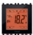
02952 Elektroniczny termostat z ekranem dotykowym do stero- wania temperaturą otoczenia 2 niezależnych stref, stan- dard KNX, 1 wyjście przełącznikowe NO 4 A 24 V~, 1 wejście czujnika temperatury 20432 lub 02965.1, 1 programowalne wejście cyfrowe, czarny - 2 moduły. Głębokość: 38,5 mm
