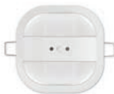
01529.1 Wykrywacz z czujnikiem obecności na podczerwień o zakresie działania 360° do włączania/wyłączania światła w zależności od naświetlenia i/lub ruchu, regulowane pole naświetlenia w zakresie 0-1000 luksów, standard KNX, instalacja na suficie. Wymiary: 91x91x45 mm
