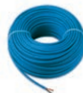
01840.E.B Kabel do rozpraszania dźwięku, 2x0.50 mm 2 , z osłoną z LSZH, Klasa CPR Eca, nadaje się do instalacji przy użyciu przewodów kategorii I (U0 = 400 V), niebieski - 100 m
