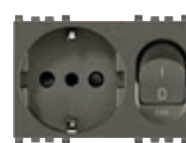
19276.M 16 A P30 250 V~, 1P+N C 16 - 3 moduły. Głębokość: 39,6 mm
