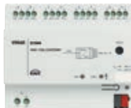
01544 Bramka DALI KNX, 8-kanałowa do 16 lamp na każdy kanał, 6 modułów x 17,5 mm
