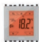
02952.BN Elektroniczny termostat z ekranem dotykowym do stero- wania temperaturą otoczenia 2 niezależnych stref, stan- dard KNX, 1 wyjście przełącznikowe NO 4 A 24 V~, 1 wejście czujnika temperatury 20432 lub 02965.1, 1 programowalne wejście cyfrowe, neutralny - 2 moduły. Głębokość: 38,5 mm
