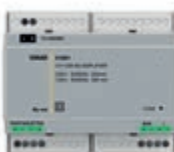
01901 Wzmacniacz stereofoniczny 2 wyjścia do rozpraszaczy dźwięku 8 \Omega 10 + 10 W, zasilanie 110-230 V 50/60 Hz, wbudowany terminator linii, 6 moduły x 17,5 mm
