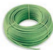
01890.E Kabel KNX, 2x2x0,8 mm, z osłoną z LSZH, Klasa CPR Eca, nadaje się do instalacji przy użyciu przewodów kategorii I (U0 = 400 V), zielony - 100 m
