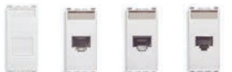
20337.6.B Kat. 6, UTP, z pokrywą. Głębokość: 26,1 mm 20338.8.B Netsafe, Kat. 5e, UTP. Głębokość: 23,6 mm 20339.4.B Netsafe, Kat. 5e, UTP 110. Głębokość: 24,7 mm 20339.5.B Netsafe, Kat. 5e, FTP 110. Głębokość: 36,15 mm
