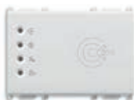
14457 Czytnik kart zbliżeniowych (transponderowych) do instalacji na zewnątrz pomieszczenia, standard KNX, 2 wyjścia przełącznikowe NO 4 A 24 V~, 2 wejścia, 12-24 V~ 50/60 Hz i 12-24 Vdc (SELV) - 3 moduły. Dostarczony bez kart zbliżeniowych (transponderowych). Głębokość: 36 mm 14457.TR Jak wyżej, przystosowany do warunków tropikalnych
