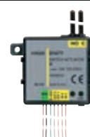
01477 Moduł z 2 programowalnymi wejściami cyfrowymi do styków bezpotencjałowych, 1 wyjście przełącznikowe do sterowania światłami NO 10 A 120-230 V~ 50/60 Hz, 2 wyjścia do pilotowania LED, systemu automatyki domowej By-me, do zabudowy
