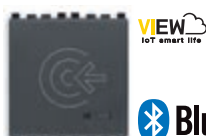
20462 Zewnętrzny czytnik inteligentnych kart NFC/RFID przed drzwiami, konfiguracja kart za pomocą aplikacji View Wireless standardowa technologia Bluetooth, technologia IoT na standardowej technologii bezprzewodowej Bluetooth® 5.0 do wdrożenia systemu View Wireless mesh, 1 wyjście przekaznikowe NO 16 A 100-240 V~ 50/60 Hz, 1 wejście DND, dioda LED z regulacją intensywności świecenia, zasilanie 100-240 V~ 50/60 Hz - 2 moduły. Głębokość: 32 mm
