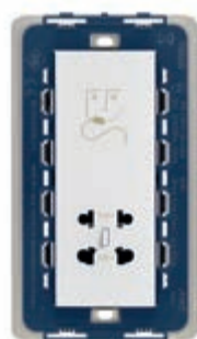
19291.B 6 230 V~ 50/60 Hz, z izolowanym transfor- matorem 20 VA, wyj- ścia 120 V~ i 230 V~. Głębokość: 41,5 mm
