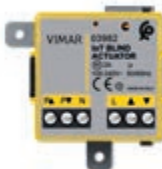
03982 Aparat sterujący do 1 rolety z orientacją listew z wyjściami przekaźnikowymi dla silnika cosφ 0,6 2 A 100-240 V~ 50/60 Hz, zdalnego sterowania, technologia bezprzewodowa Bluetooth® 5.0 dla systemu mesh View Wireless i Zigbee 3.0, instalacja do zabudowy
