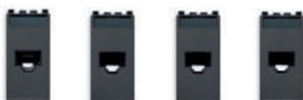
20339.6 Netsafe, Kat. 6, UTP 110. Głębokość: 22,3 mm 20339.11 Netsafe, Kat. 5e, UTP. Głębokość: 30,3 mm 20339.13 Netsafe, Kat. 6, UTP. Głębokość: 30,3 mm 20339.14 Netsafe, Kat. 6, FTP. Głębokość: 30,3 mm
