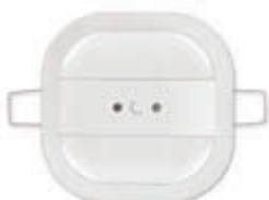
01527 Wykrywacz z czujnikiem obecności na podczerwień o zakresie działa- nia 360° do ciągłego włączania/ wyłączania światła, ogrzewania, klimatyzacji, wentylacji w zależności od naświetlenia i/lub ruchu, regulo- wane pole naświetlenia w zakresie 1-1000 luksów, standard KNX, instalacja na suficie. Wymiary: 80x80x45 mm
