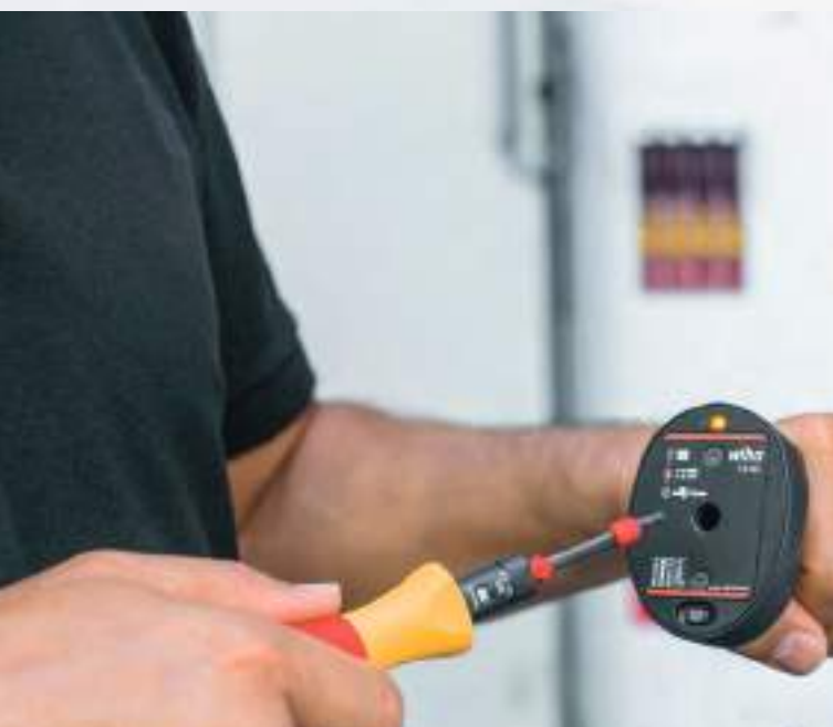
Przenośny tester narzędzi dynamometrycznych
