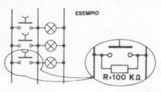
Il funzionamento del temporizzatore Art. 1051 è subordinato all'allacciamento di un carico minimo (neon 40 W - elettronico 16 W - incandescenza 10 W) in quanto in assenza di carico il prodotto non funziona.
