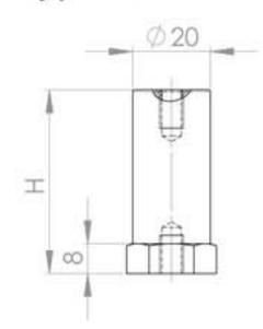
Aus Polyglas-Polyestermasse, mit Glasfaser verstärkt, rot, selbstverlöschend. Auf Anfrage können die Isolatoren vom Typ CO/P mit einem oder zwei Gewindebolzen bestückt geliefert werden. Zur Selbstsicherung sind diese
