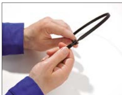
1. Wprowadź taśmę opaski przewężeniem w otwartą część główki.
