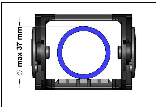
La chaîne 4760 est **entièrement fermée**, elle convient à tous types d'applications sur les machines outils. Sa robustesse et son passage intérieur important permettent de guider des flexibles ou tuyaux de diamètre 37 mm.
