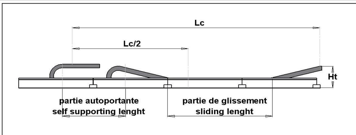
Si la chaîne utilisée dépasse sa longueur autoportante, il convient d'utiliser un chenal de guidage linéaire sur la longueur totale de la course (les dimensions des goulottes et chenaux sont en fin de catalogue).
