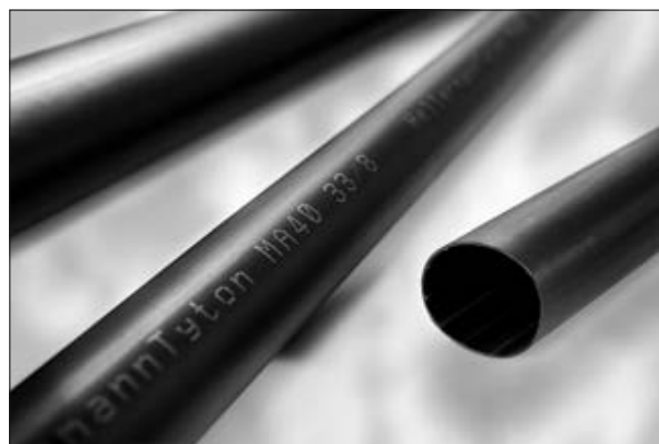
MA40 cienkościenna, samogasnąca, rura termokurczliwa z klejem o stopniu skurczu 4:1, do przemysłu stoczniowego.
