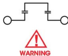
SEZIONARE SOLO IN ASSENZA DI TENSIONE
