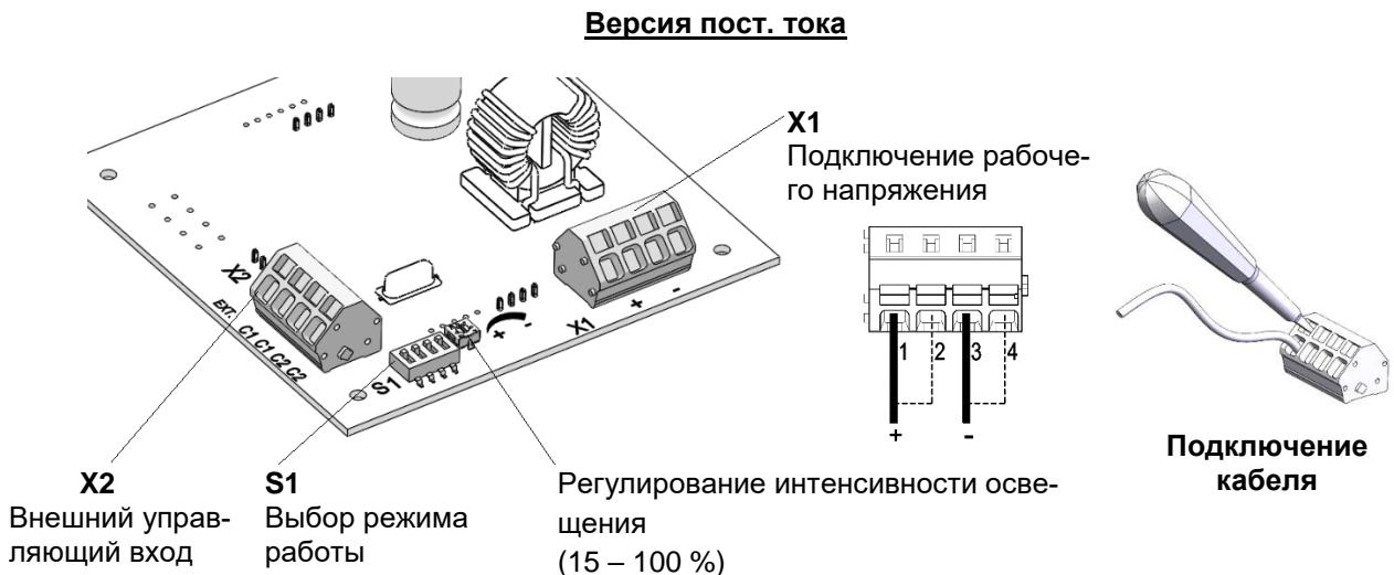
**Указание:** Устройства, работающие от напряжения пост. тока, оснащены защитой против инверсии полярности. При неправильной полярности подключения гарантируется функционирование устройства.
