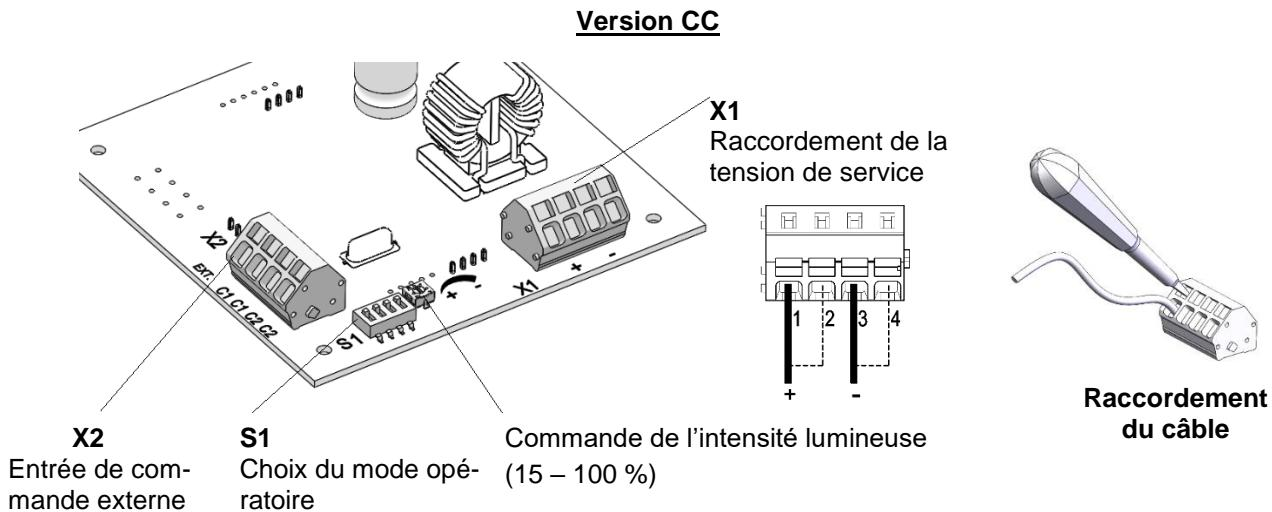
**Remarque :** les appareils à tension continue (CC) sont dotés d'une protection contre l'inversion de polarité. Le fonctionnement est garanti en cas d'inversion de polarité des raccordements.
