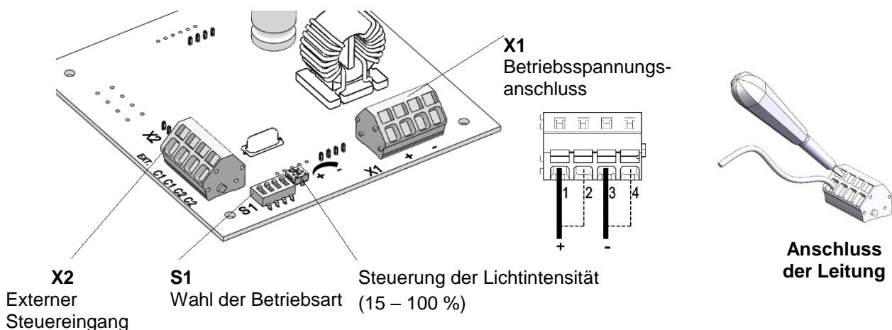
**Hinweis:** Geräte mit DC-Spannung sind mit einem Verpolungsschutz ausgerüstet. Bei Verpolung der Anschlüsse ist die Funktion gewährleistet.
