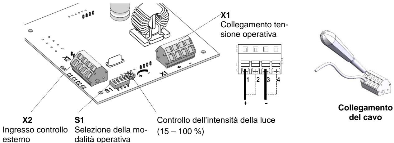
**Nota:** Gli apparecchi in cc sono dotati di protezione da inversione di polarità. In caso di inversione di polarità il funzionamento è garantito.
