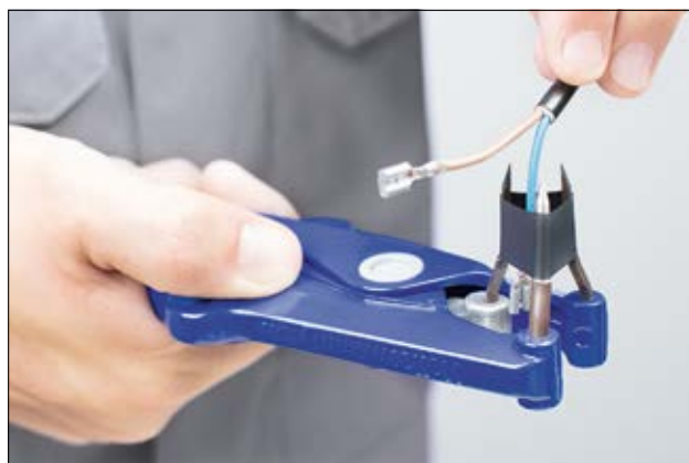
Szybka i bezpieczna aplikacja oznaczników i tulejek przy pomocy rozwieraka trójzębnego.
