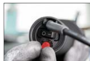
Regulacja temperatury pracy H6100.
