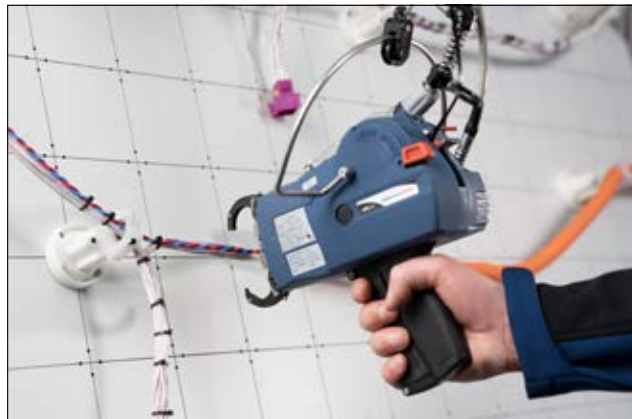
Autotool ATS flex z zestawem do pracy w podwieszeniu.
