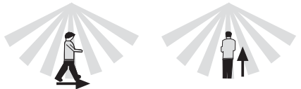
Bewegungen parallel zu Sensor (normale Entdeckungsreihe) Direkt auf den Sensor Bewegen (senken Sie Entdeckungsreihe)
