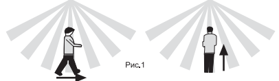
Рис.1 При движении касательно датчика (Нормальное расстояние восприятия) При перпендикулярном движении к датчику (Пониженное расстояние восприятия)
