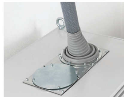
Przepust kablowy kabla zasilającego przez dach szafy stosując płytę modułową. Otwór montażowy 314x144mm.
