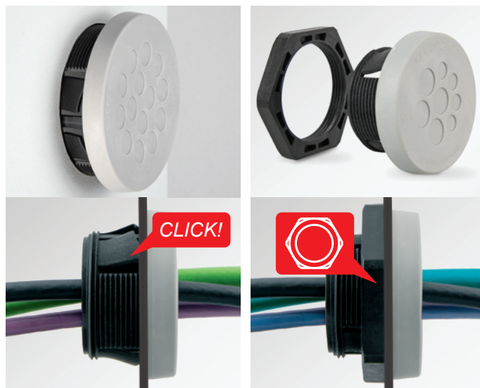
Sposób montażu 1: Zatrzasknij w wycięciu Do ścian o grubości 1 – 2,5 mm
