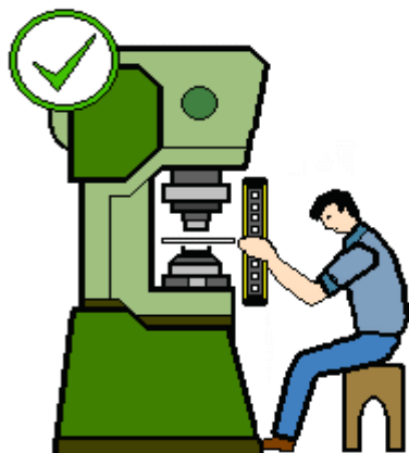
Zabezpieczenie od frontu
