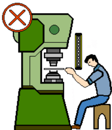
Dostęp do strefy niebezpiecznej pod kurtyną
