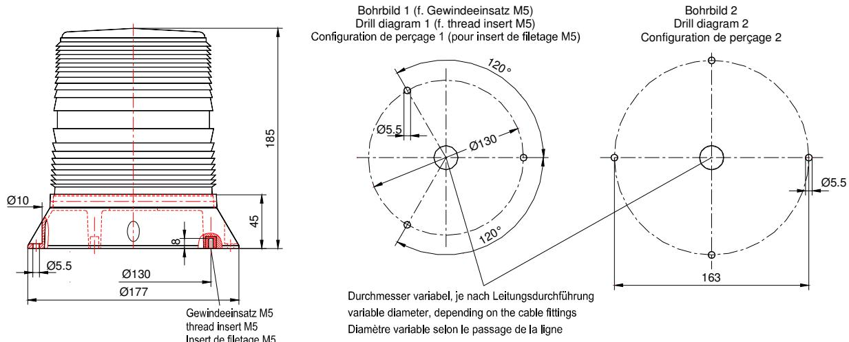
Für die Befestigung der Leuchte (Direktmontage) stehen zwei unterschiedliche Bohrbilder zur Verfügung. Für die Befestigung nach Bohrbild 1 sind Gewindeeinsätze M5 x 8 am Boden der Leuchte eingelassen. Bohrbild 2 ermöglicht die Befestigung mit 4 durchgehenden Schrauben oder ähnlichen von oben. Die Bohrung für die Leitungsdurchführung ist dieser anzupassen. Als Bohrschablone kann die beigelegte Gummidichtung verwendet werden. Achten Sie bei der Montage auf ebenen Untergrund (Dichtung!).
